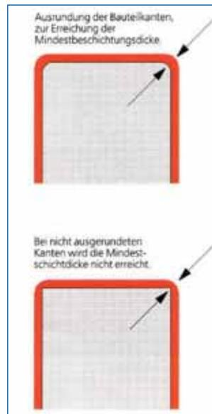
Abbildung 8: Kantenausrundung (aus [8])
